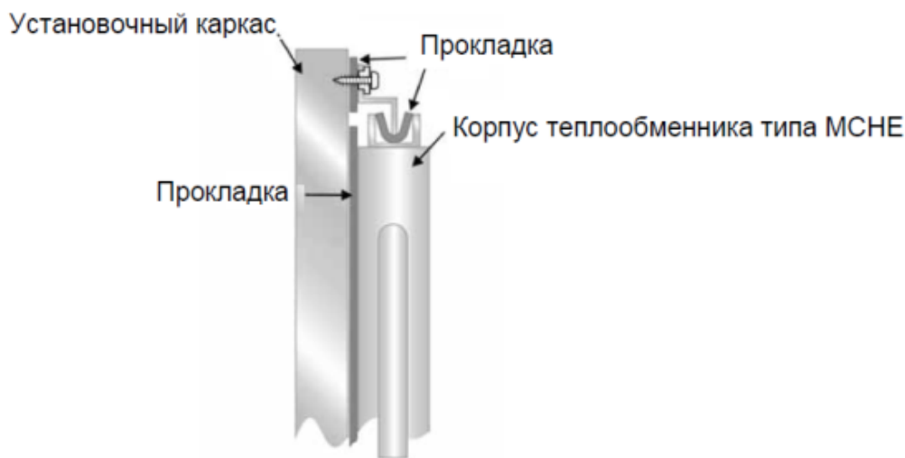
Монтаж теплообменников микроканальных типа МСНН.
